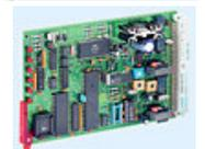
G7-SELCALL – radio interfejs za spajanje pojedinačnih radio sistema s intercom sistemom
