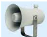
HP10 – horna – zvučnik koristi se u otvorenim prostorima i bučnim halama. Zvučnik je konstruisan od ABS plastike i otporan je na atmosferske prilike. Frekvencijska pokrivenost 410 do 8000 Hz. Snaga 10/15W. Zvuk 106 dB
