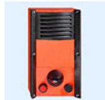
EE8107 - digitalna industrijska podstanica s ugrađenim zvučnikom, dinamički mikrofonom (3 do 50 cm udaljenost od mikrofona) i s dve programirane tipke od kojih je jedna za indikaciju poziva, DSP tehnologija, IP65
