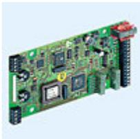
ET808 – intercom modul u DSP tehnologiji za ugradnju u digitalne stanice i podstanice s 2 inputa i 2 relejna outputa. Električni mikrofoni MIC480 uključen
