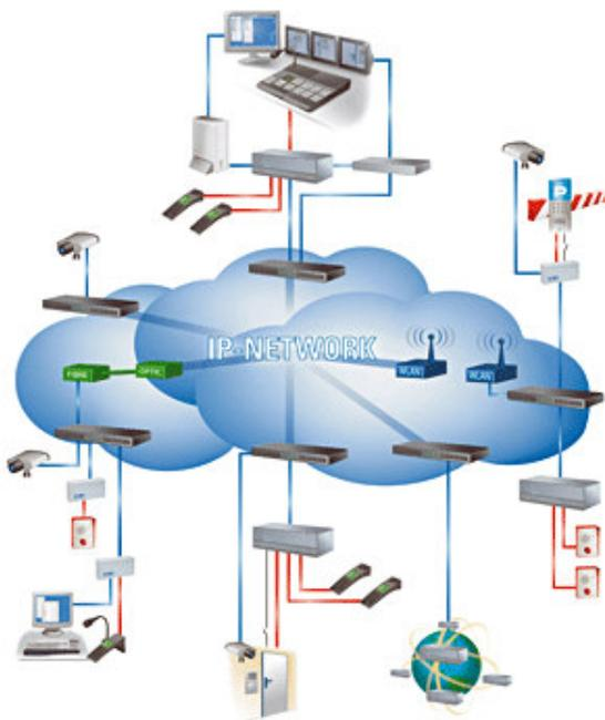
ET901-X je IP komunikacijski interfejs koji omogućava priključak bilo kojeg standardnog interkom aparata na Ethernet (LAN/WAN) mrežu. Time se, putem ovog interfejsa, standardni interkom aparat pretvara u IP terminal, koji je spojen na interkom server putem IP mreže. ET 901-X IP box ima ugrađen 2-port switch, što pruža mogućnost priključka i druge IP opreme preko iste komunikacijske tačke (IP kamera i sl).
