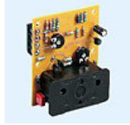
ET502 – intercom modul, analogni, s mikrofonom i pojačalom. Povezivanje na zvučnik i pozivnu tipku. Primena: liftovi, rampe i sl.
