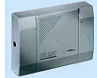
GE 200 – centrala za 32 korisnika. Aparati mogu biti analogni i digitalni. Kompaktno plastično kućište idealno je za zidnu ugradnju. Osnovna centrala uključivši napajanje nudi 5 slotova. Od 1-4 su za interfonske kartice i/ili interfejsa. Slot A je za interfejs.
