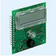
ET411 – analogni intercom modul za interfone s alfanumeričkim displejom (6 znakova). Sadrži električni mikrofon i crvenu lampicu. Veza na zvučnik i tastaturu (15 tipki) i slušalicu.
