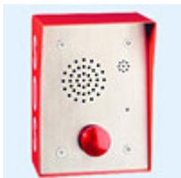
EF562 – analogna podstanica posebno konstruirana za specifične uslove (otporna na udarce, vandalizam). Metalno kućište otporno na prašinu i vodu (IP54). Prednja ploča je od 3 mm debelog čelika sa specijalnim zavrtnjevima. Ima pozivnu tipku, električni mikrofoni i zvučnik.
