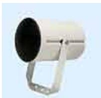
RB36-04 – zvučnik cilindričnog oblika s elektro dinamičkom membranom. Koristi se kao spoljni zvučnik npr. aerodromi, benzinske stanice. Frekvencijski opseg: 250 do 10000 Hz. Snaga 5 W. Zvuk 92 dB
