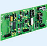
ET601 – analogni intercom modul za ugradnju u specijalne industrijske interfone. Spajanje na 18 programibilnih tipki. Ugrađeno 8W pojačalo (2 nova jačine zvuka, moguće podešavanje). Za specijalne stanice s više direktnih pozivnih tipki u bučnim prostorima
