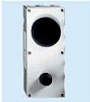
EG151 – zvučnik koji se koristi u bučnim prostorima. Mogućnost ručnog prebacivanja na višu ili nižu jačinu zvuka. Koristi se kao dopuna industrijskom aparatu EE561/ EE571. Frekvencijsko područje: 300 do 6000 Hz, izlazna snaga 5 W. Zvuk 80 dB
