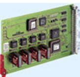
G7-GED-DSP – komunikacijski interfejs - kartica za priključak digitalnih terminala, odnosno 4 AF audio izvora (radio komunikacijski kanal, muzika, alarm).
