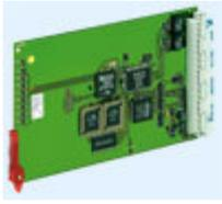
G7-DSP-IP-8 – IP komunikacijski interfejs - kartica za priključak 8 intercom aparata na Ethernet (LAN/WAN) mrežu. Ugrađeni switch omogućava priključak sledeće IP kartice, te tako ne zahteva dodatni LAN priključak na switch ili router. Makimalno 6 IP kartica može biti ugrađeno u GE700 IP server.
