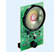
ET509 – analogni intercom modul s pojačalom s mikrofonom i zvučnikom. Jedna pozivna tipka
