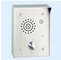
EF862 – digitalna podstanica posebno konstruisana za specifične uslove (otporna na udarce, vandalizam). Metalno kućište otporno na prašinu i vodu (IP54). Prednja ploča je od 3 mm debelog čelika sa specijalnim zavrtnjevima. Ima pozivnu tipku, električni mikrofoni i zvučnik.
