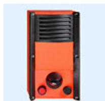
EE8106 – digitalna industrijska podstanica s ugrađenim zvučnikom, električnim mikrofonom (max. 7 m udaljenost) i s dve programirane tipke od kojih je jedna za indikaciju poziva, DSP tehnologija, IP65
